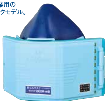
サカサ式 1005R-08型 国家検定合格第TM540号 指定防護係数10
